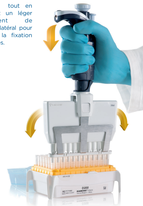
Figure 7 Mise en place des pointes jetables sur pipette mono et multicanaux
